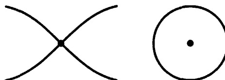
Figur 2.2 Kritisk punkt af type sadde og center. For sadde er tegnet seperatricer, og for centeret er en enkelt strømning vist.
