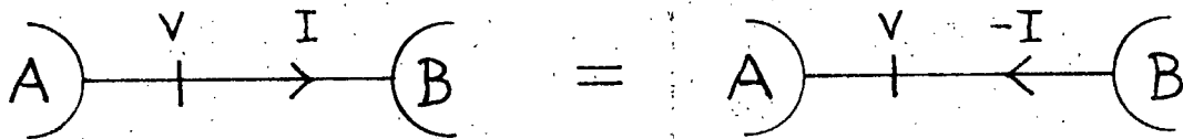
Fig.2. Illustration af strøm-orienteringsreglen. De to diagrammer fremstiller samme fysiske situation. Energistrømmen i pilens retning er i begge tilfælde produktet af de symbolske udtryk for strømmen og spændingen.
